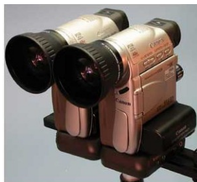
Abbildung 2.5: Doppelkamera, 2 x Canon Elura mini-DV Camcorder [8]
